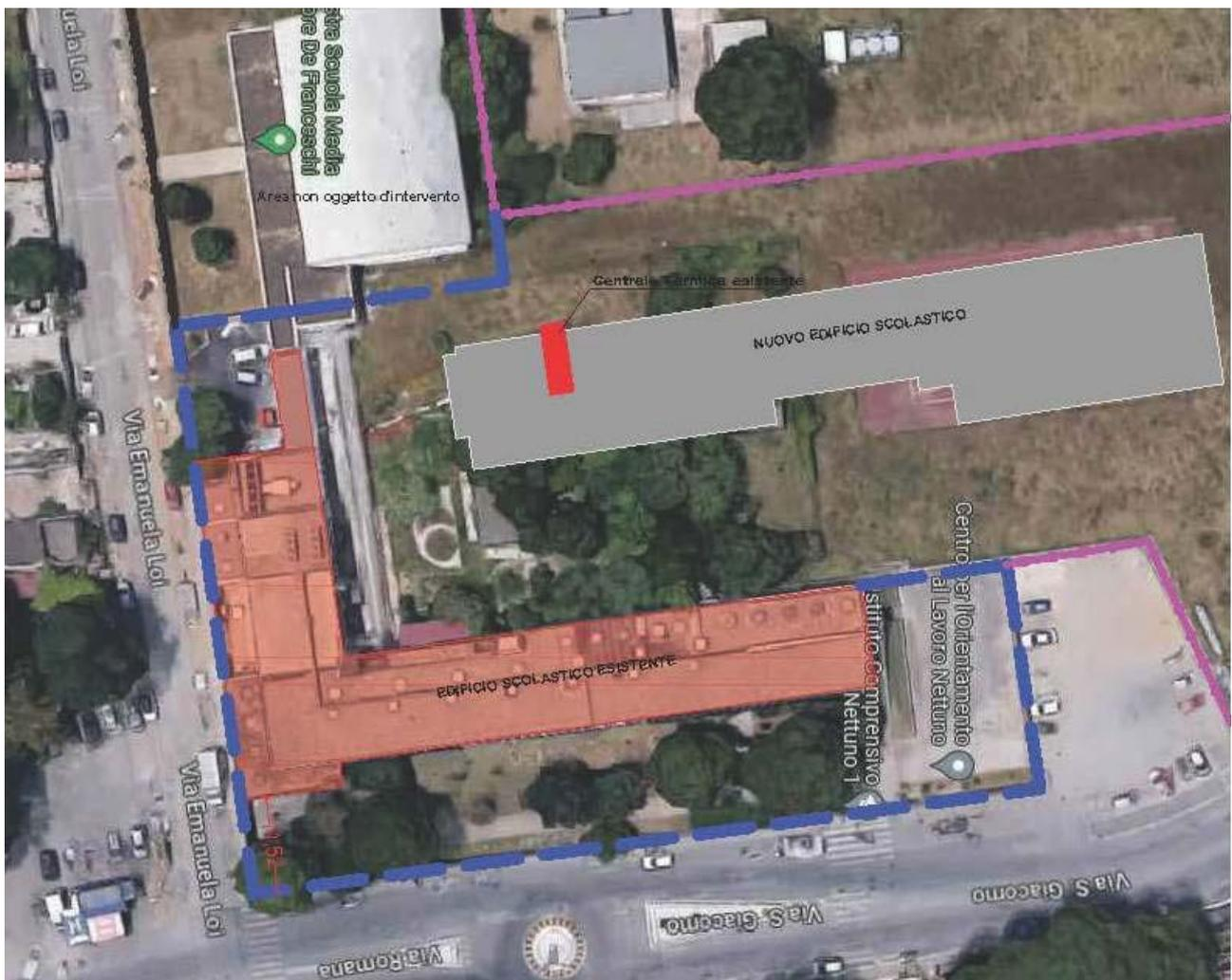
Si provvederà anche ad individuare degli appositi percorsi, sia carrabili che pedonali, in modo tale che l'organizzazione del cantiere possa permettere la piena accessibilità anche attraverso la parzializzazione dell'area con idonee recinzioni e mediante la realizzazione di percorsi temporanei.
