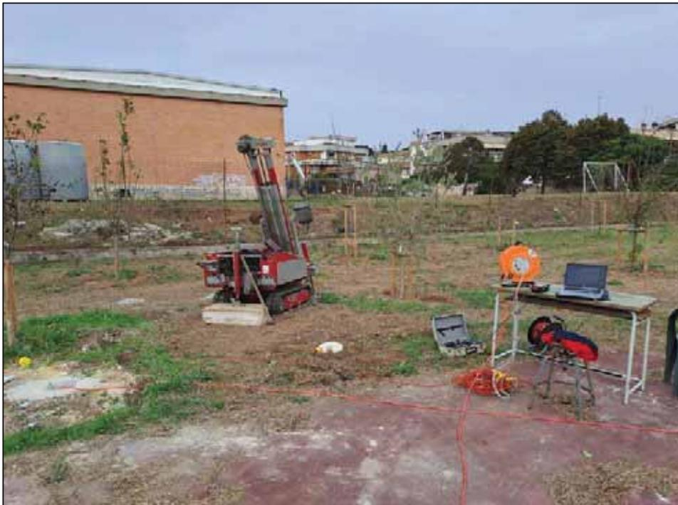
**FOTO 85 – S7 – Postazione prova sismica down-hole**
