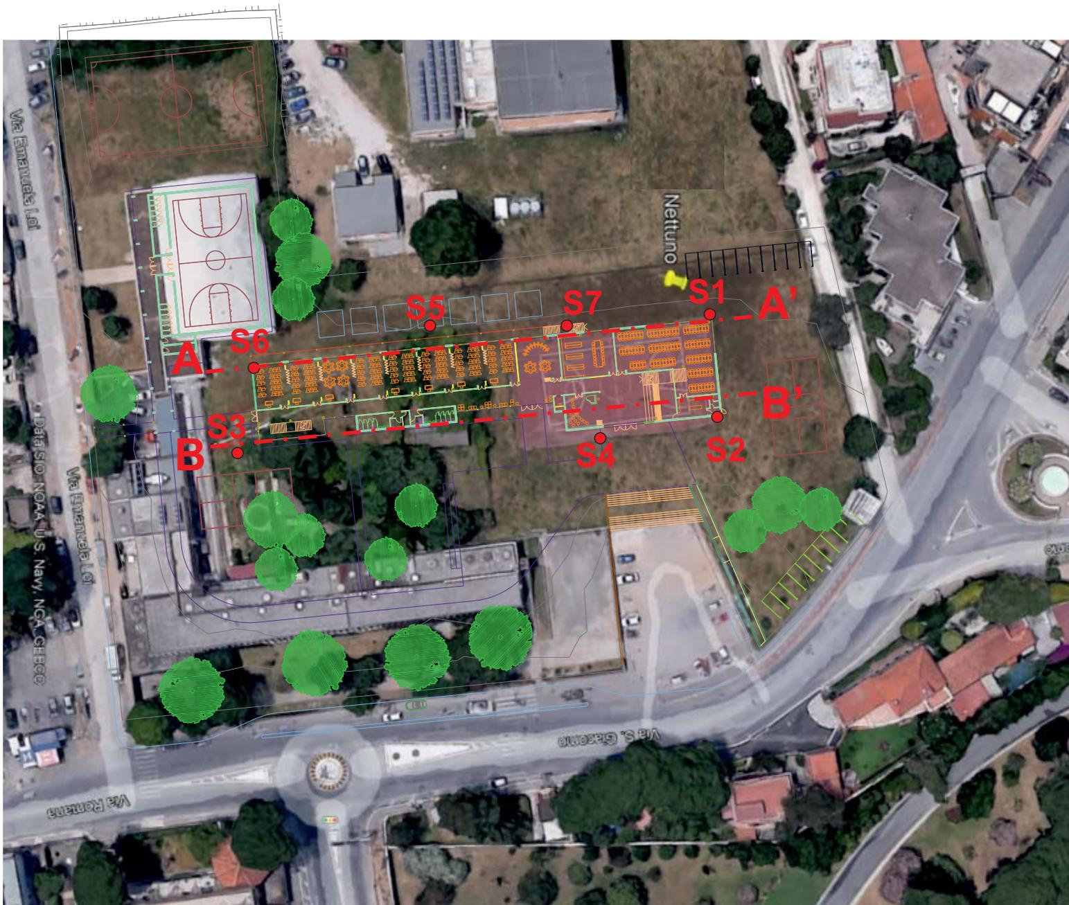
**Schema planimetrico: sovrapposizione della planimetria generale di progetto e di immagine Google con ubicazione dei sondaggi geognostici eseguiti con le direzioni delle sezioni A - A', B - B'**
