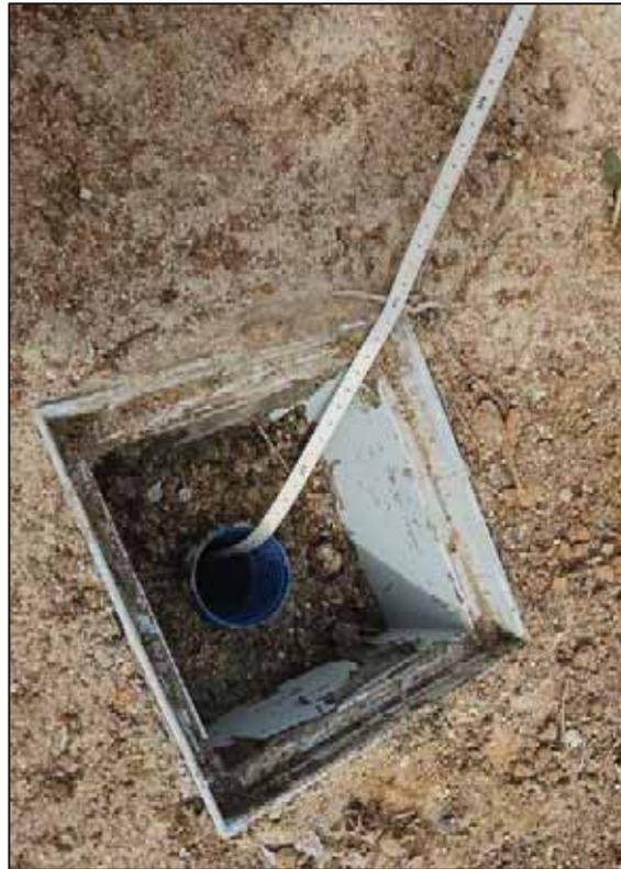
**FOTO 86** – S1 – misura freaticometrica nel foro S1
