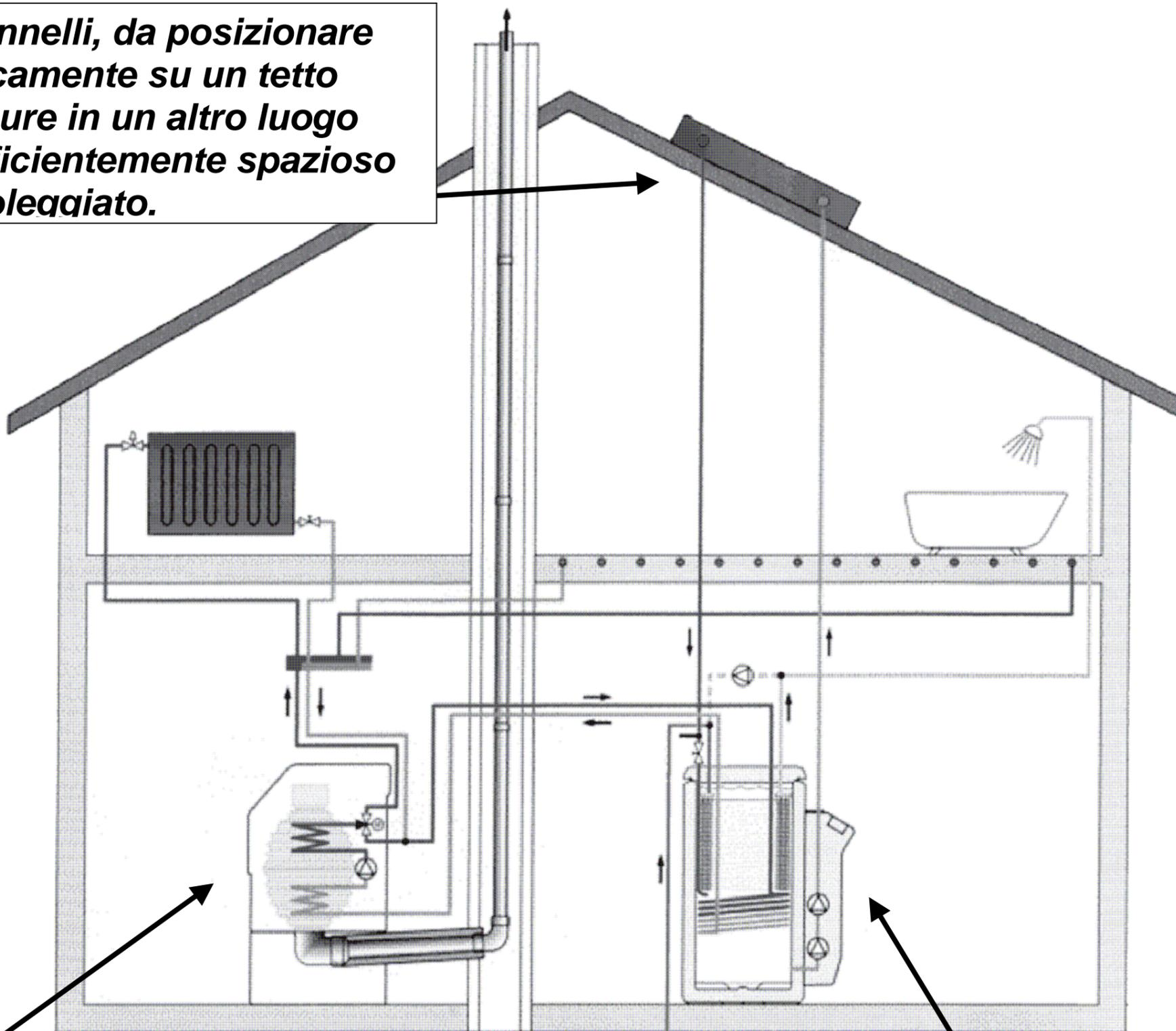
*Una caldaia che serve per integrare il calore nei momenti di necessità*
